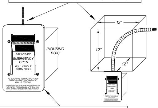
FACE PLATE MUST BE INSTALLED DIRECTLY TO THE HOUSING BOX BEHIND (AS SHIPPED) OR THE RELEASE WILL NOT WORK... LEAVE NO SPACE BETWEEN THEM!
